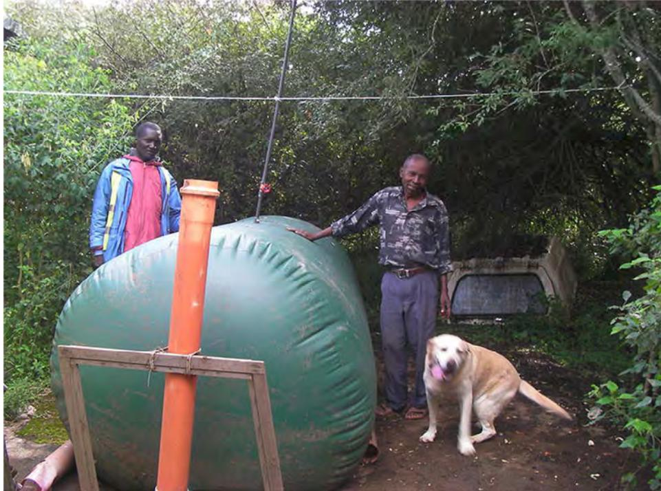
*Illustration 8 : Digesteur préfabriqué en matériau flexible*
